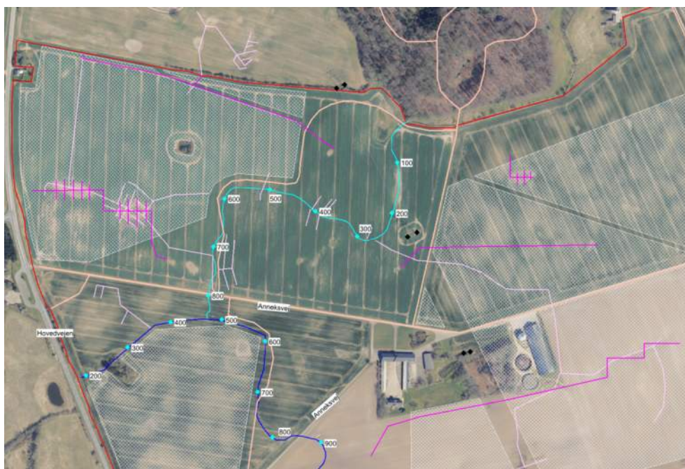
Figur 7 Omlægning af dræn (lilla=nye dræn, lyslilla=digitaliserede efter drænkort, skraveret=byggefelt, brun streg=ny sti)
